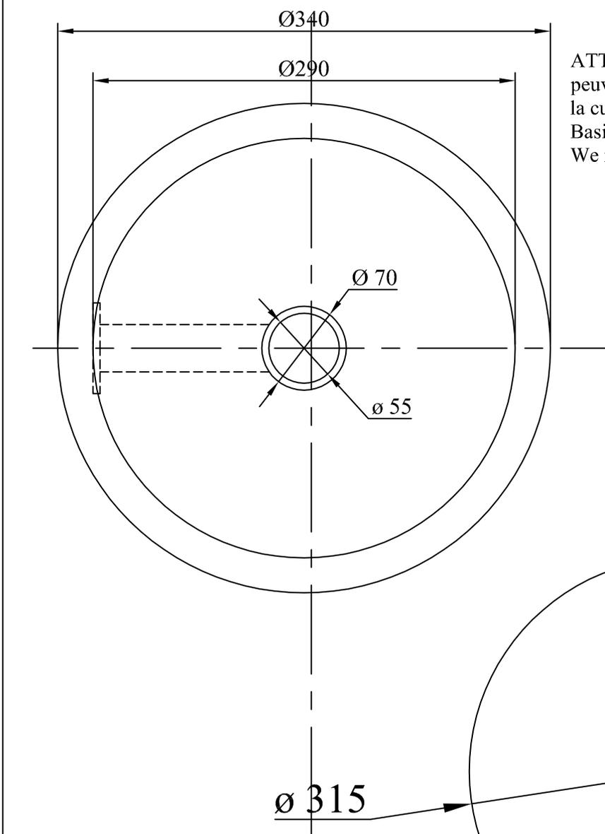
ATTENTION : Cuve réalisée à la main : Les dimensions peuvent être variables. Nous recommandons de recevoir la cuve pour percement et installation
