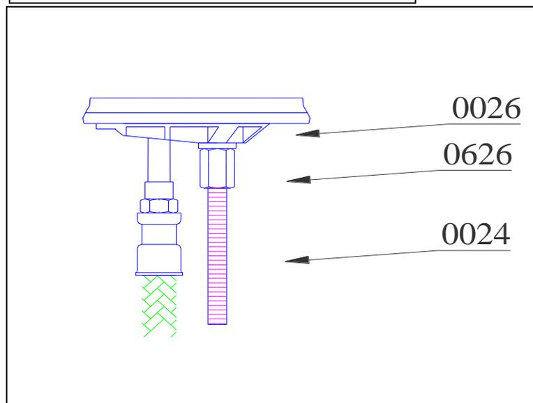
Enfiler les 2 croissant de fixation (rep0025 et 0026) sur le tube fileté (rep0024) jusqu'au dessous du plan de travail.
