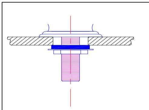
Vérifier que le robinet est bien serré et positionné sur le plan de travail, puis raccorder les alimentations
