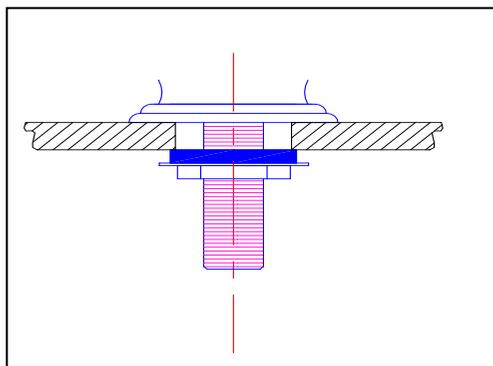
Vérifier que le robinet est bien serré et positionné sur le plan de travail, puis raccorder l'alimentation.
